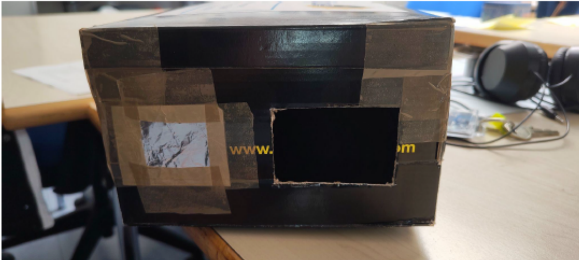
Vu de la boîte du côté du sténopé et de l'ouverture pour l'observation
